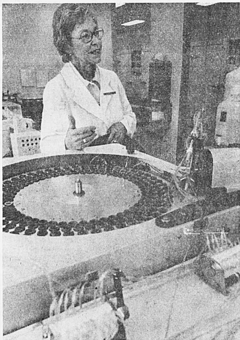
Géraldine Brown, technologiste-chef, surveille un des deux auto-analyseurs qui contiennent 200 spécimens de sang chacun et effectuent 15 tests sur 124 spécimens à l'heure.
