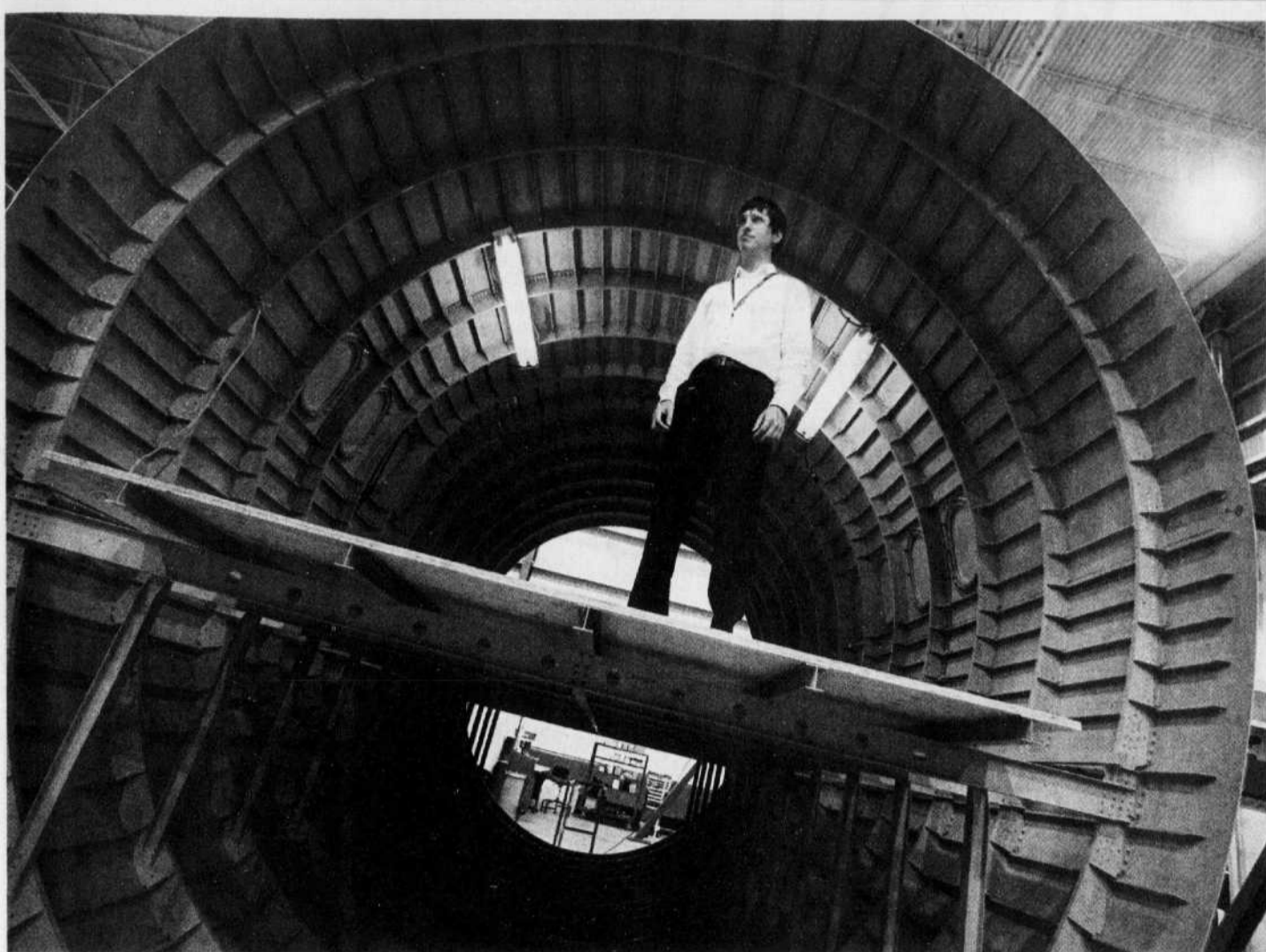
L'ingénieur Patrick Tessier pose à l'intérieur du futur fuselage d'un appareil de la CSeries. Le premier cylindre d'essai de ce fuselage a été livré récemment à Dorval par son fabricant chinois.
