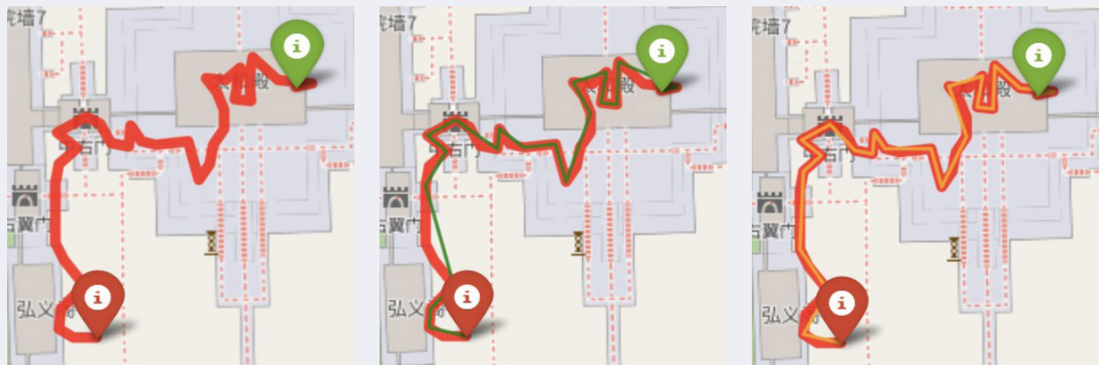
FIGURE 3 – Comparaison d'une même trajectoire simplifiée par différents algorithmes de gauche à droite, la trajectoire originale, trajectoire simplifiée avec l'algorithme SP sur l'originale et trajectoire simplifiée avec l'algorithme DP sur l'originale.
