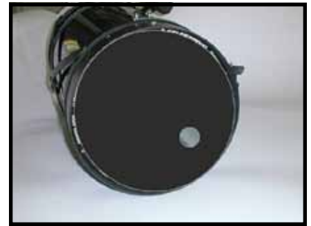
Le cache peut être fait de papier cartonné noir mat ; il couvre complètement l'ouverture avant du télescope. Un trou bien rond (~50 mm de diamètre) hors axe, entre les soutiens du secondaire, sert d'ouverture sous-dimensionnée au télescope.
