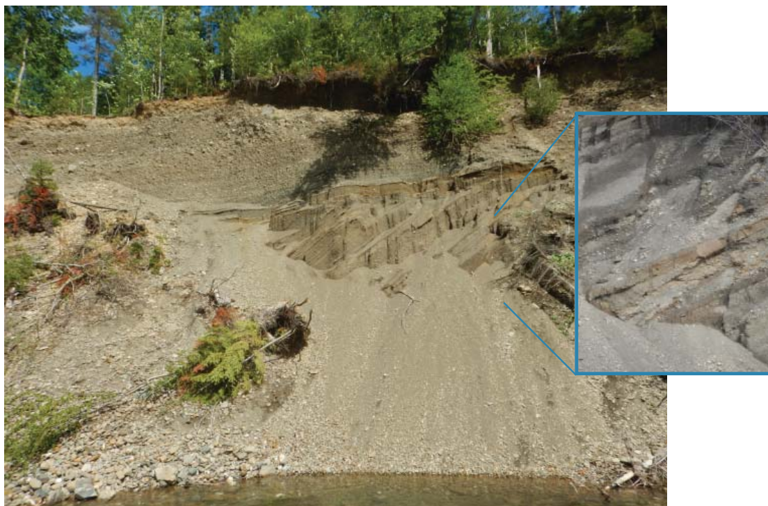
Photo 17: Coupe naturelle formée de 3 à 5 m de galets (50 à 70%) grossièrement stratifiés reposant sur un niveau de sable moyen à grossier et de galets (10 à 30 %) en lits obliques qui totalise 5 à 7 m d'épaisseur. Présence de lits décimétriques de sable silteux (site 140, 22H04).
