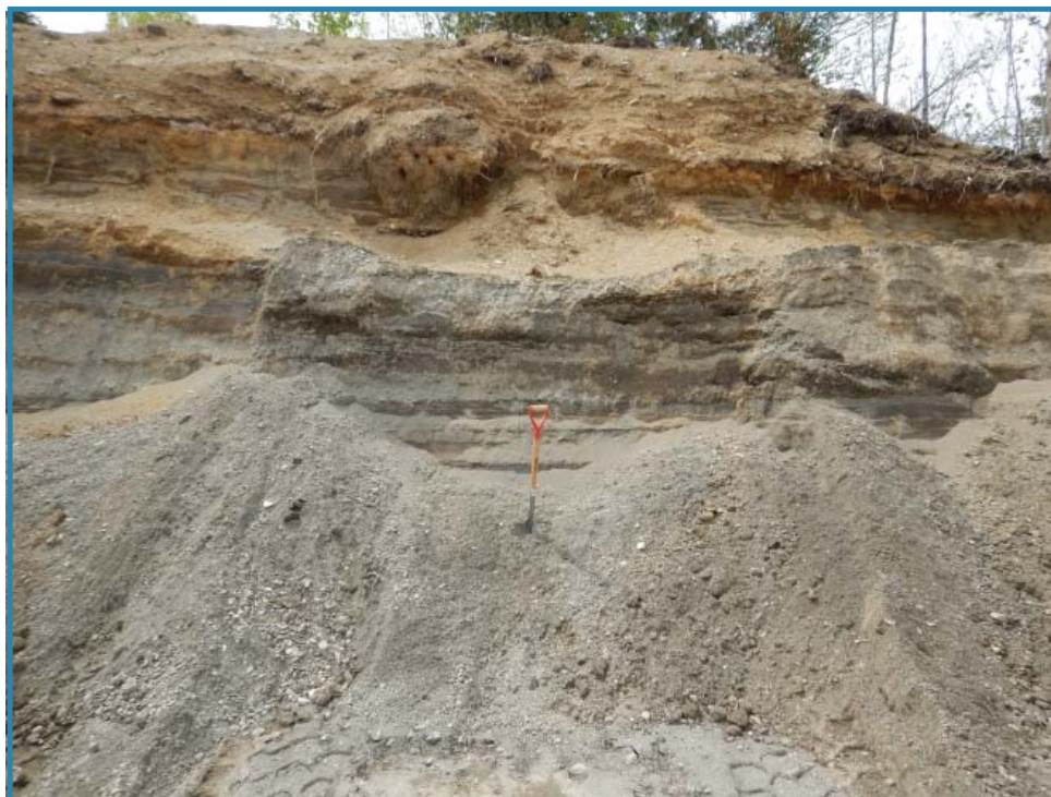
Photo 1: Face de 3 à 4 m de hauteur composée de sable moyen à grossier stratifié avec 5 à 20 % de galets (site 8, 22B13).
