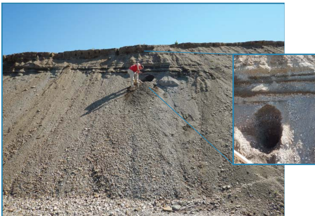
Photo 10: Face de 6 m de hauteur composée de sable grossier et de galets fins stratifiés et bien triés (20 à 40 %) pouvant être utilisés comme granulats pour le sable à béton (site 34, 22G02).
