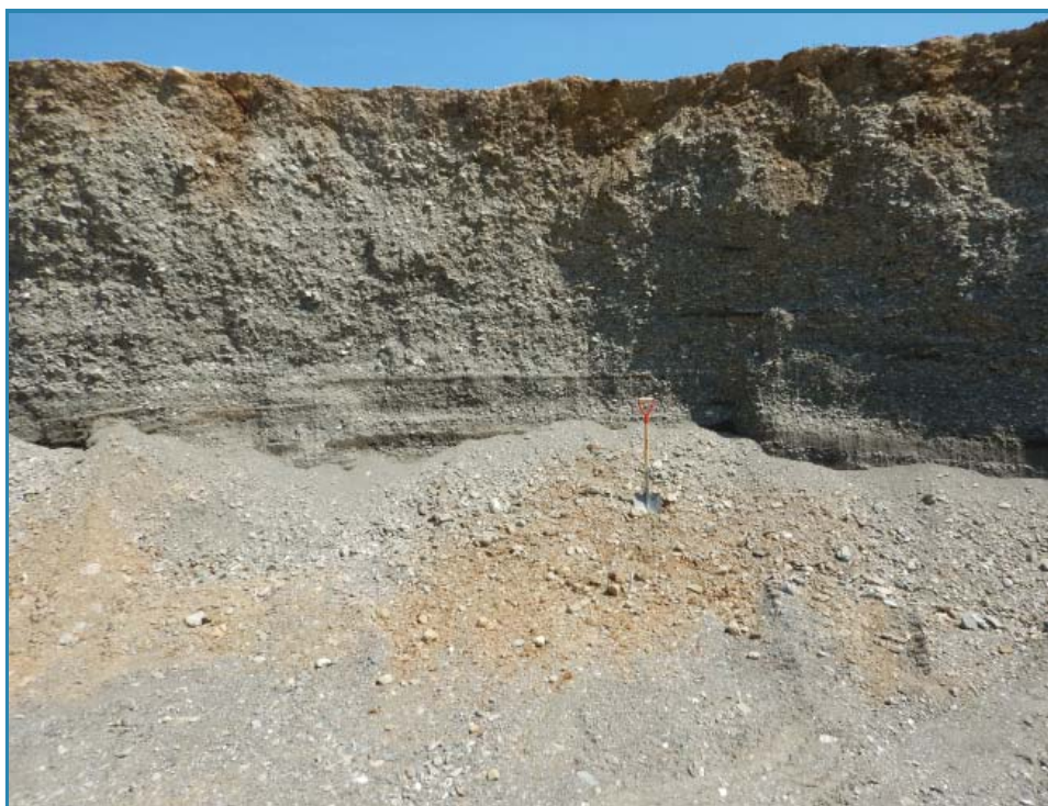
Photo 14: Face de 3 à 5 m de hauteur composée de galets (40 à 60 %) jointifs par endroits. Ailleurs, les galets sont contenus dans une matrice sableuse et stratifiée (site 40, 22B15).
