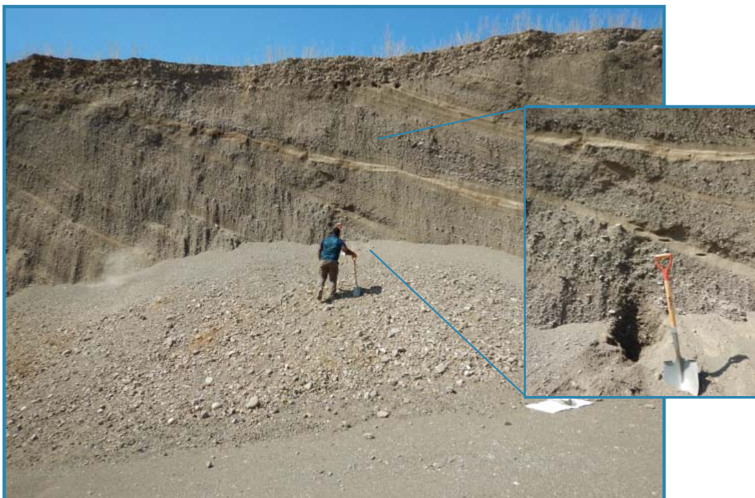
Photo 22: Palier supérieur du site 112 (22H03). Face de 5 à 6 m de hauteur constituée d'une alternance de lits de sable moyen à grossier et de lits de gravier avec quelques interstratifications de sable fin à silteux.
