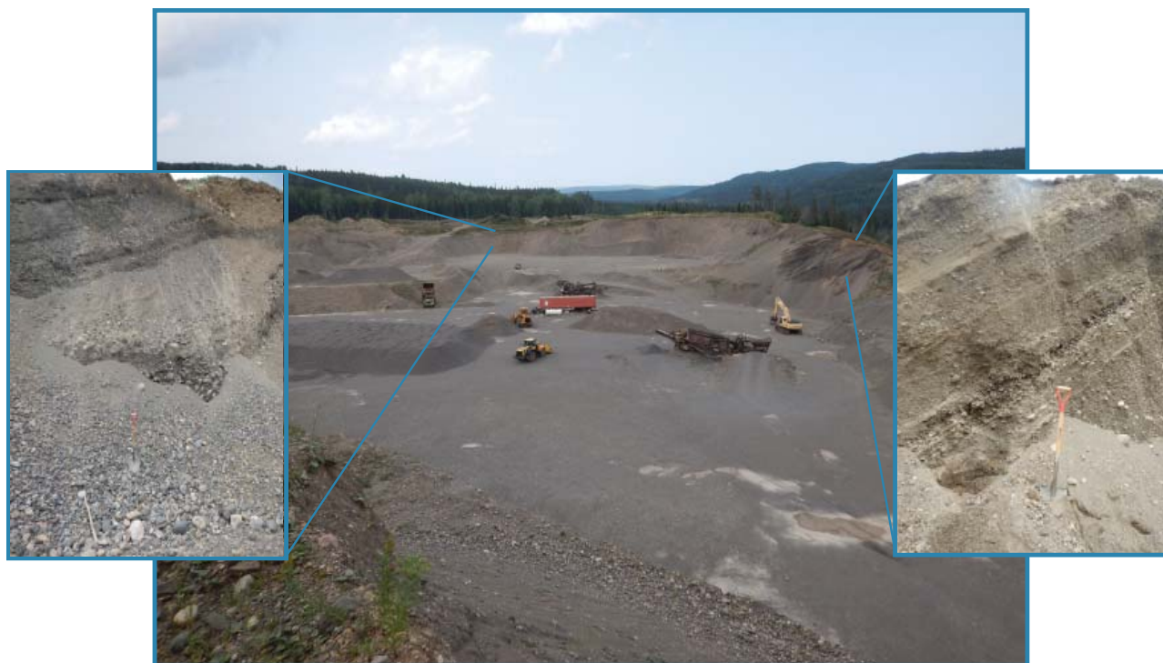
Photo 19: Vaste exploitation active qui expose des faces fraîches de 15 à 20 m de hauteur. Ces faces montrent une alternance de lits obliques composés de galets jointifs, de sable graveleux et de sable moyen à grossier. La proportion de galets varie selon l'endroit (site 107, 22H04).
