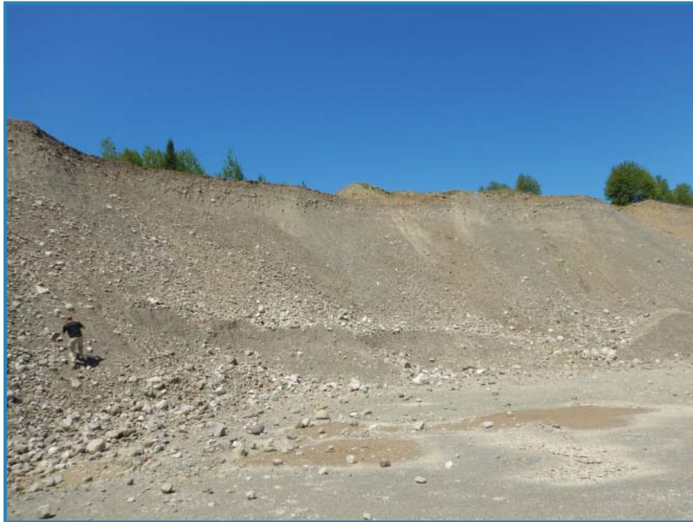
Photo 5: Face de 10 m de hauteur composée de galets et de quelques cailloux arrondis dans une matrice sableuse sans structure (site 313, 22B11).
