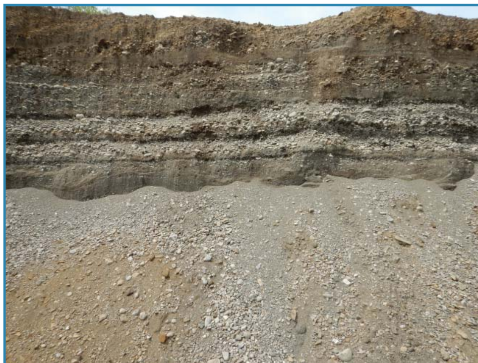
Photo 2: Face de 3 à 4 m de hauteur composée de sable moyen à grossier stratifié avec 20 à 40 % de galets (site 8, 22B13).
