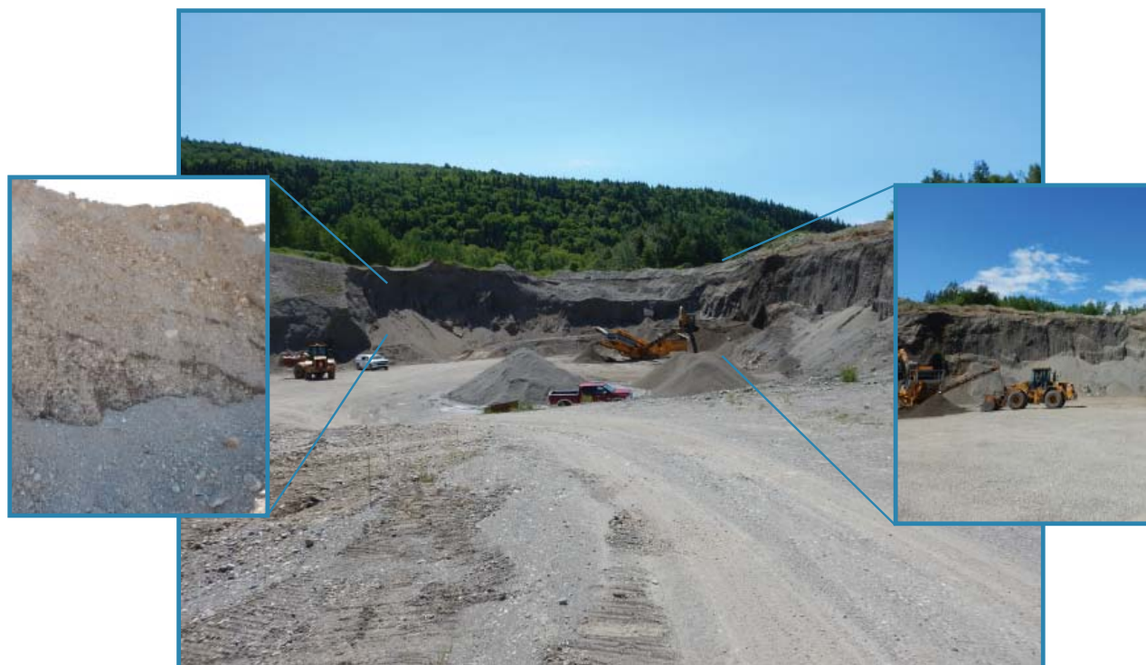
Photo 15: Importante exploitation dans le secteur de Sainte-Anne-des-Monts. Faces de 8 à 16 m de hauteur composées de sable graveleux ou de gravier formant des lits obliques (site 53, 22G02).
