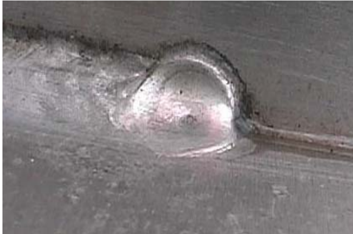
Photographie 5.7-2 Évaluation du comportement des assemblages soudés CEC 5 – Cratère indiquant le début ou la fin de la procédure de soudage
