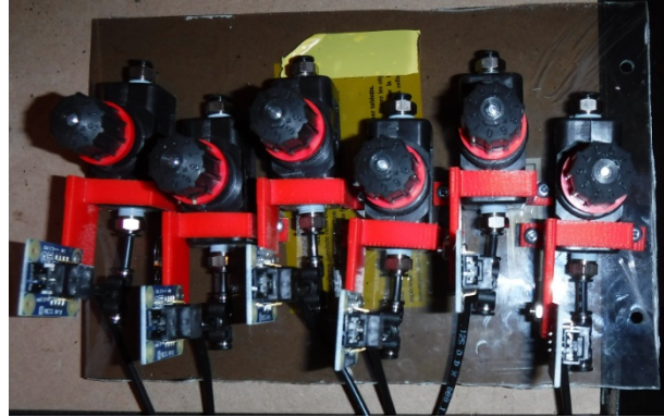
Figure 14 Image du régulateur de pression (a) et photo de l'assemblage des valves de précision et des capteurs de pression (b)
