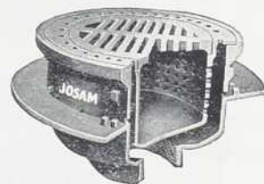
Série no 5440 Drain de plancher non obstructible avec récipient à sédiment amovible.
