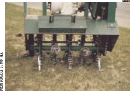
Aérateur de sol
