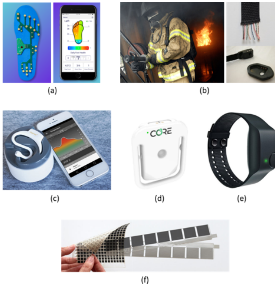
Figure 9. Exemples de dispositifs portables, disponibles dans le commerce et dédiés à la saisie de la température en temps réel : (a) capteur thermique intégré dans une semelle (par Flextrapower - anciennement Bonbouton, New York, NY, É.-U.), (b) capteur thermique intégré dans un vêtement de pompier « VIKING Life-Saving Equipment » (par Ohmatex, Viby, Danemark), (c) dispositif intra-auriculaire portable Degree° (par Cosinuss°, Munich, BY, Allemagne), (d) capteur thermique connecté CORE™ (par GreenTEG, Zurich, Suisse), (e) bracelet E4 (par Empatica, Boston, MA, É.-U.), (f) capteurs flexibles « Thermistor » et « TiM and XY-T Array » (par PST, Ndabeni, Cape Town, Afrique du Sud).
