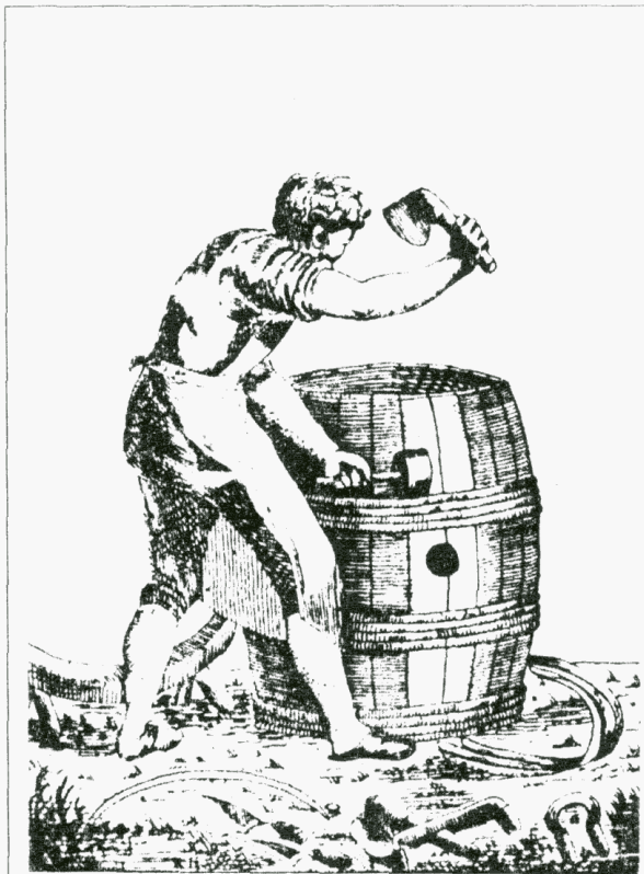
À l'arrière plan, se trouve une selle à rogner; de gauche à droite, deux cochoirs bien tranchants, servant à tailler les cercles, une tille de rabattage, de forme inusitée, une plane droite et une à genou. Gravure sur cuivre, fin du XIXe siècle. Paris, Bibliothèque nationale, Estampes. Photo provenant de: «Les tonneliers du Québec»
