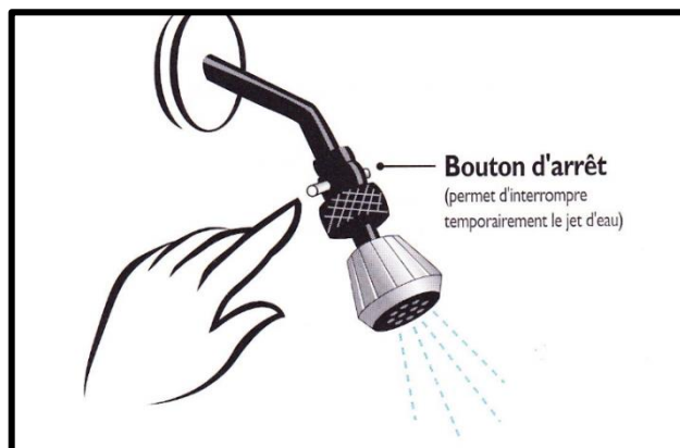
Figure 16. Pomme de douche à faible débit avec bouton d'arrêt
