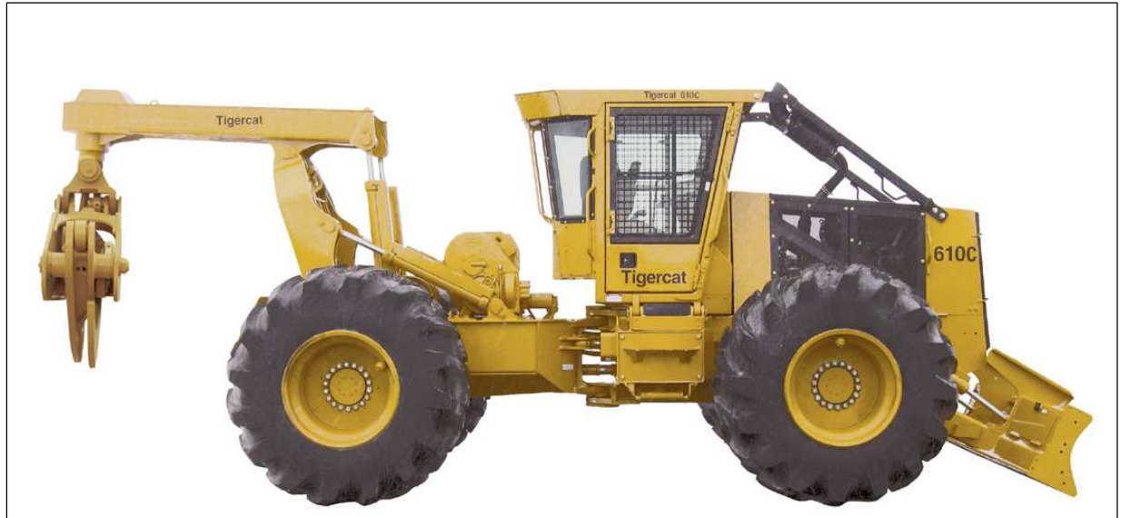
Figure 5 Illustration d'un débardeur à pince
