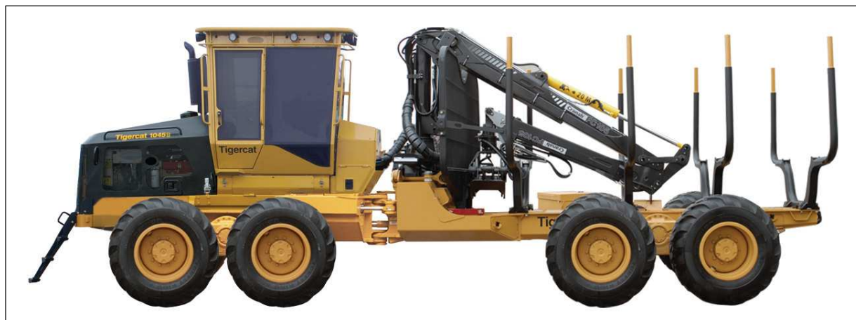
Figure 3 Illustration d'un porteur forestier
