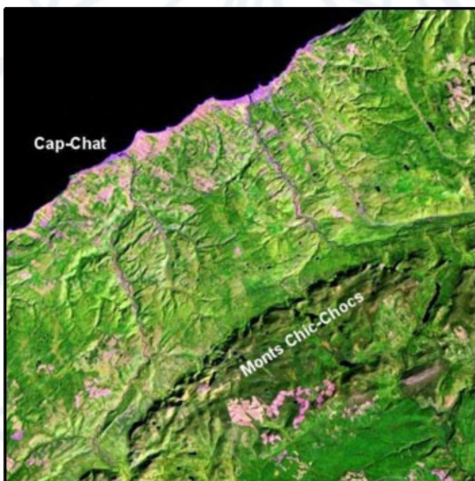
Cet extrait d'une image Landsat-TM, captée le 1 er septembre 1999, montre bien que les monts Chic-Chocs constituent un obstacle naturel aux vents dominants, causant ainsi des problèmes de mesures aux éoliennes installées près de Cap-Chat.
