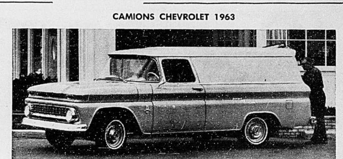
La gamme des camions Chevrolet 1963 comporte de nouveaux moteurs 6-cylindres, plus légers, un nouveau moteur 4-cylindres de 90 CV, pour le modèle à cabine avancée d'une demi-tonne et des essieux-avant à poutres en I avec ressorts à lames à flexibilité variable, pour les séries poids moyens et poids lourd, assurant une douceur de marche améliorée, une durée et une capacité de charge plus grandes. La camionnette présentée ici a une suspension avant à ressorts à boudin, de roulement très doux; le châssis-échelle très robuste, redessiné, et les ressorts arrière à boudin, à double effet, lui donnent la meilleure combinaison possible, de douceur de roulement et de capacité de charge. Ce modèle est muni, en équipement standard, d'un nouveau 6-cylindres de 230 po. cu., développant 140 c.v., avec 7 paliers de vilebrequin. Un 6-cylindres de même conception de 292 po. cu. et 165 CV pour service dur, ou un V8 de 283 po. cu. et 175 CV sont livrables sur demande.
