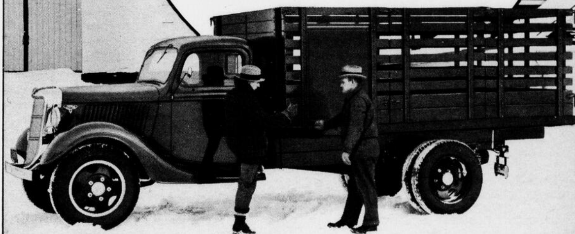
Le Camion 2 Tonnes Ford V-8 de 1936, à empattement de 157" et muni d'une caisse à ridelles.
