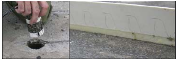
Figure 3: Carotte et plaque de déformation lors de la mise en place
