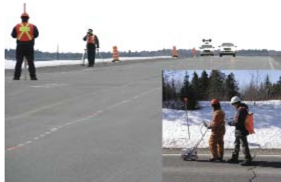
Figure 1 : Mesure des soulèvements au gel (mire et niveau et profilomètre portatif)
