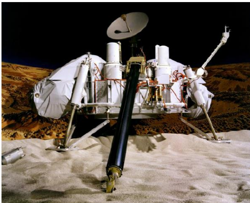
Une sonde Viking Lander , avec son bras robotique tendu vers l'avant. Remarquez la patte à gauche du bras, celle photographiée par les caméras de la sonde. Ci-haut, le responsable du projet, Thomas Young, qui donne une idée de la taille de l'engin.
