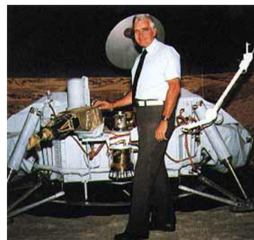
Une sonde Viking Lander , avec son bras robotique tendu vers l'avant. Remarquez la patte à gauche du bras, celle photographiée par les caméras de la sonde. Ci-haut, le responsable du projet, Thomas Young, qui donne une idée de la taille de l'engin.
