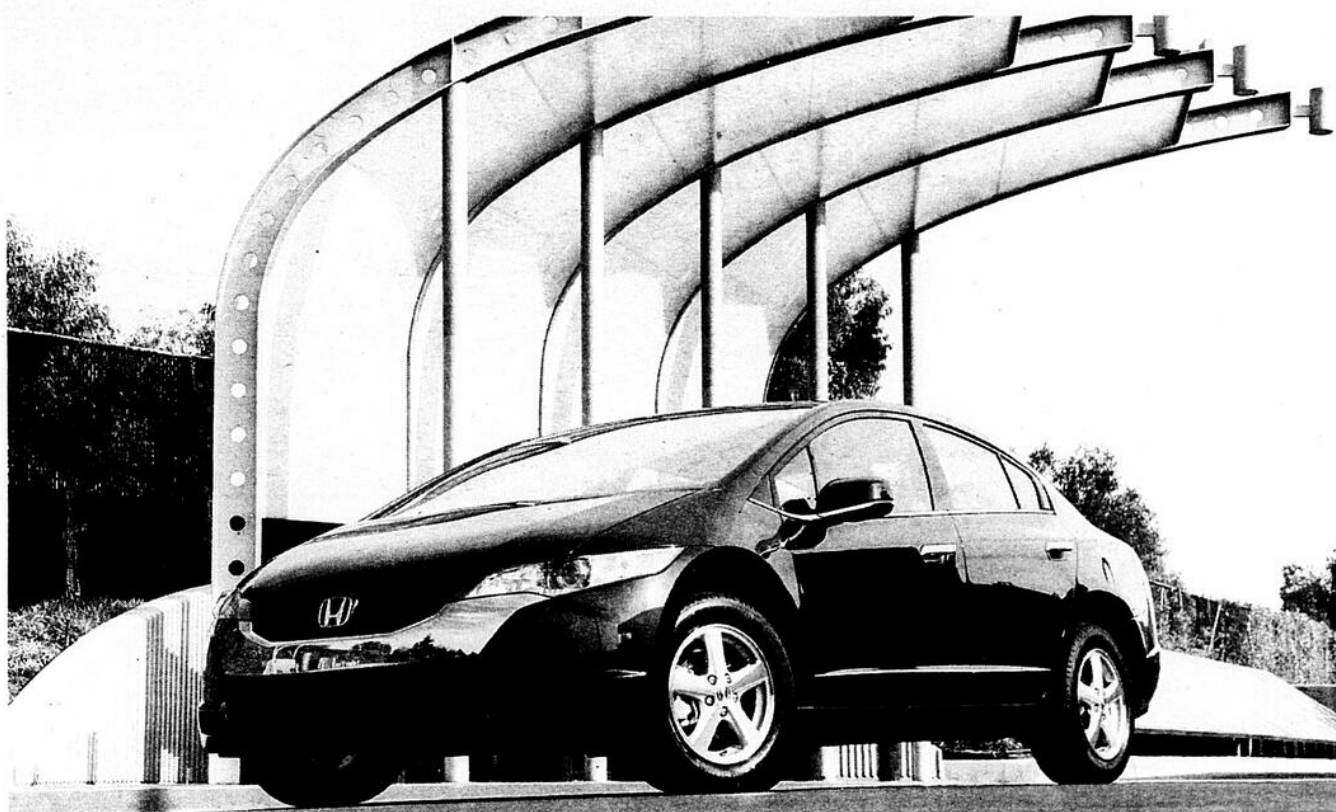
La FCX Clarity roule à l'électricité produite à bord par des piles à combustible elles-mêmes alimentées par l'hydrogène.
