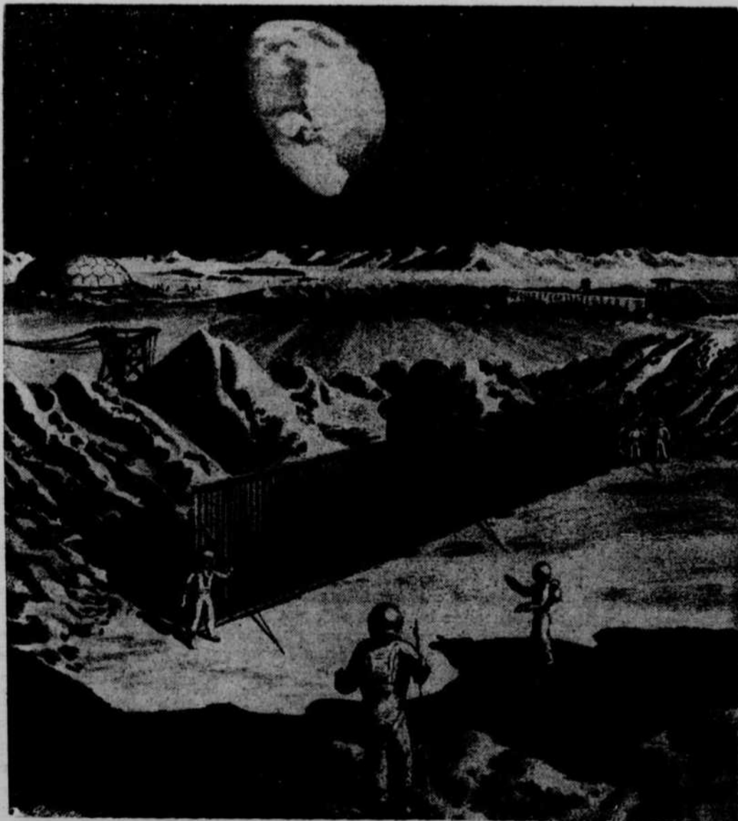
Un radiateur de 72 pieds dessert une centrale d'énergie sur la lune. Dans la centrale la chaleur d'un réacteur nucléaire vaporise le mercure à utiliser dans la turbine; puis le radiateur refroidit le mercure pour compléter le cycle.
