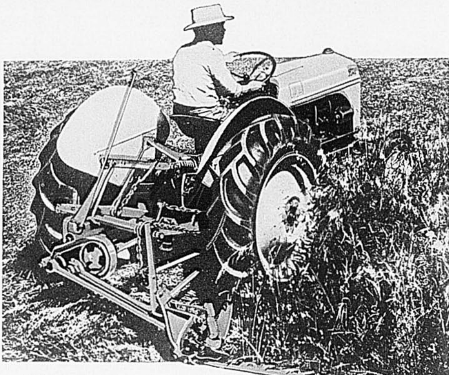
CI-DESSUS: La faucheuse d'arrière-train, du type élévatoire. La commande hydraulique Ford, actionnée au toucher, lève et baisse aisément la barre coupeuse.
