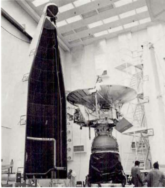
La sonde Pioneer 10 , montée sur un étage-fusée, est sur le point d'être enfermée dans la coiffe de la fusée porteuse.
