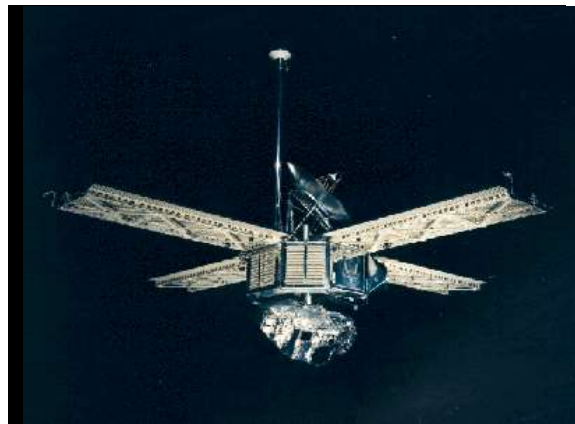
Sonde martienne Mariner munie de quatre panneaux solaires disposés en forme de croix.
