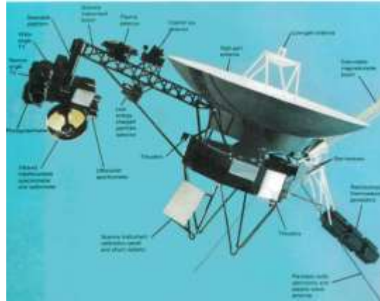
Une sonde Voyager comme telle se trouve sous une coupole parabolique (blanche). Elle porte plusieurs bras sur lesquels est fixée une foule d'équipements.
