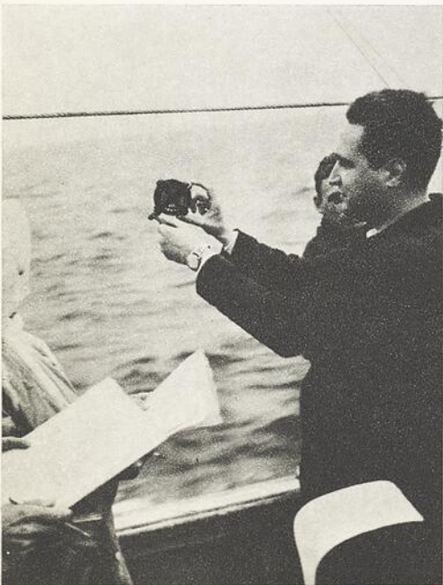
Utilisation d'un anémomètre manuel pour mesurer la vitesse du vent.
