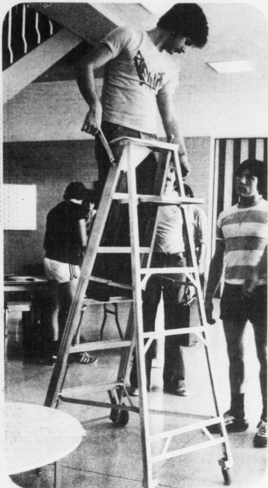
Grâce à un ingénieux système d'engrenages, un peintre pourra déplacer son escabeau sans avoir à descendre. Il lui suffira d'actionner une manivelle placée à sa hauteur.
