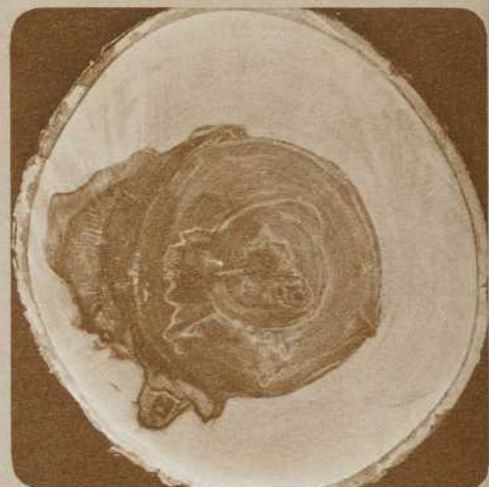
Section transversale d'un bouleau jaune d'environ 60 ans avec une coloration asymétrique.
