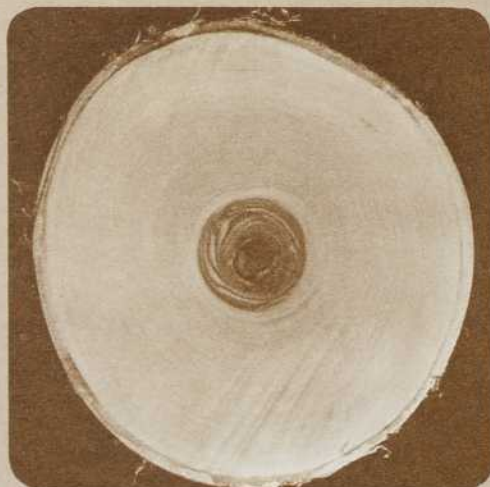
Section transversale d'un bouleau jaune d'environ 50 ans avec une partie centrale colorée.
