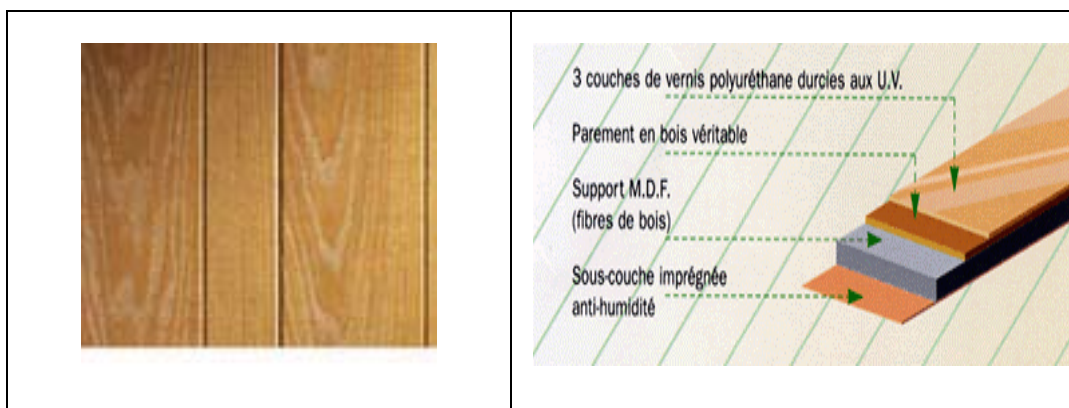
Figure 4 : Exemple de lambris en bois reconstitué à base de MDF 8
