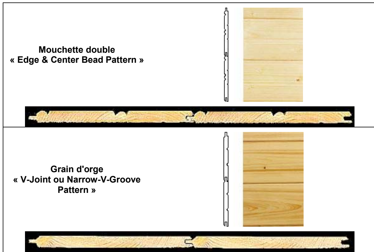
Figure 8 : Détails des profils - mouchette double et grain d'orge 11
