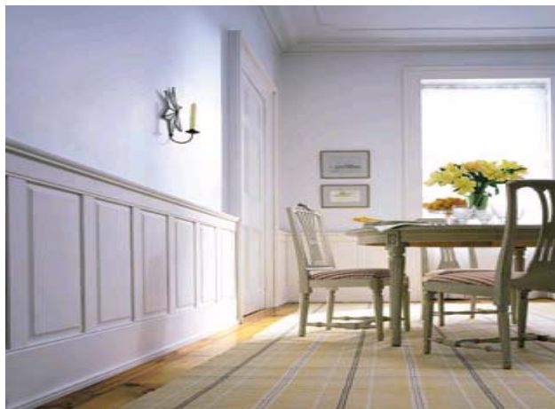
Figure 3 : Exemple d'un lambris caisson en MDF plaqué bois 6
