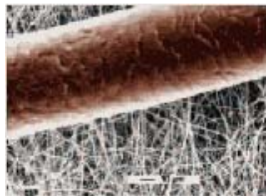
Nanofibrilles de textile qui sont dix fois plus petites en diamètre que les fibres textiles traditionnelles
