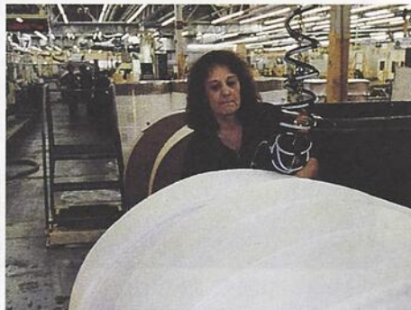
Un palan électrique permet à cette opératrice de réalimenter sa machine sans soulever le rouleau de matière première.
