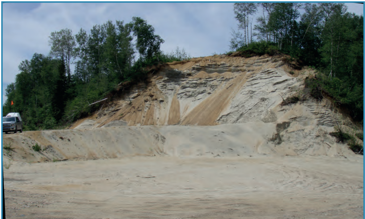
Photo 21 – Face de 8 à 10 m de hauteur sur le flanc d'un esker composée de sable moyen à grossier stratifié (site 382, 32A10).
