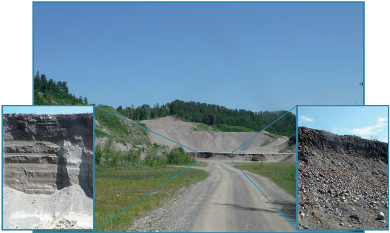
Photo 30 – Faces de 3 à 5 m de hauteur composées de galets (30 à 60 %) et de cailloux (10 à 20 %) subarrondis dans une matrice sableuse (site 118, 22D05).
