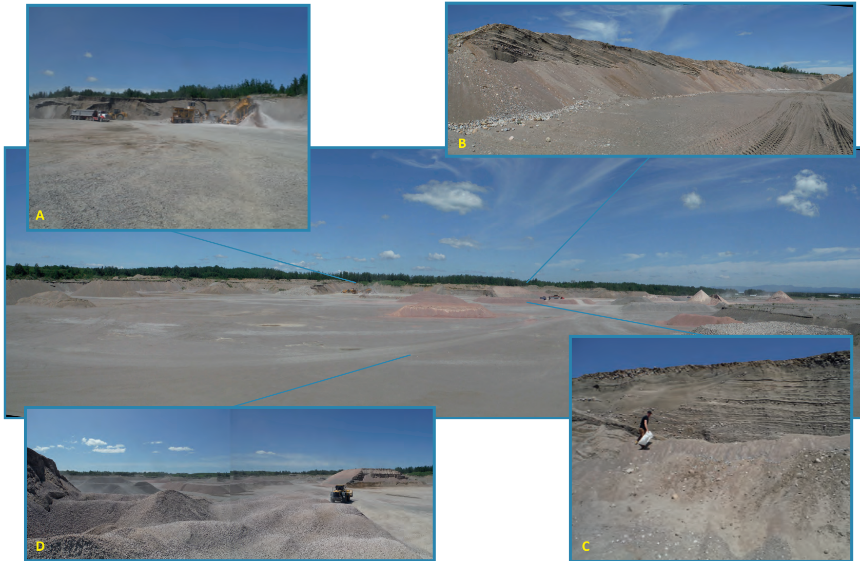
Photo 5 – Vaste exploitation commerciale. (A) Fabrication de MG-20. (B) Face de 6 à 8 m de hauteur composée de sable moyen à grossier avec des interstratifications de gravier. (C) Sable et gravier stratifié. Présence de chenaux. (D) Plusieurs piles de réserves de matériaux divers (site 187, 22D07).
