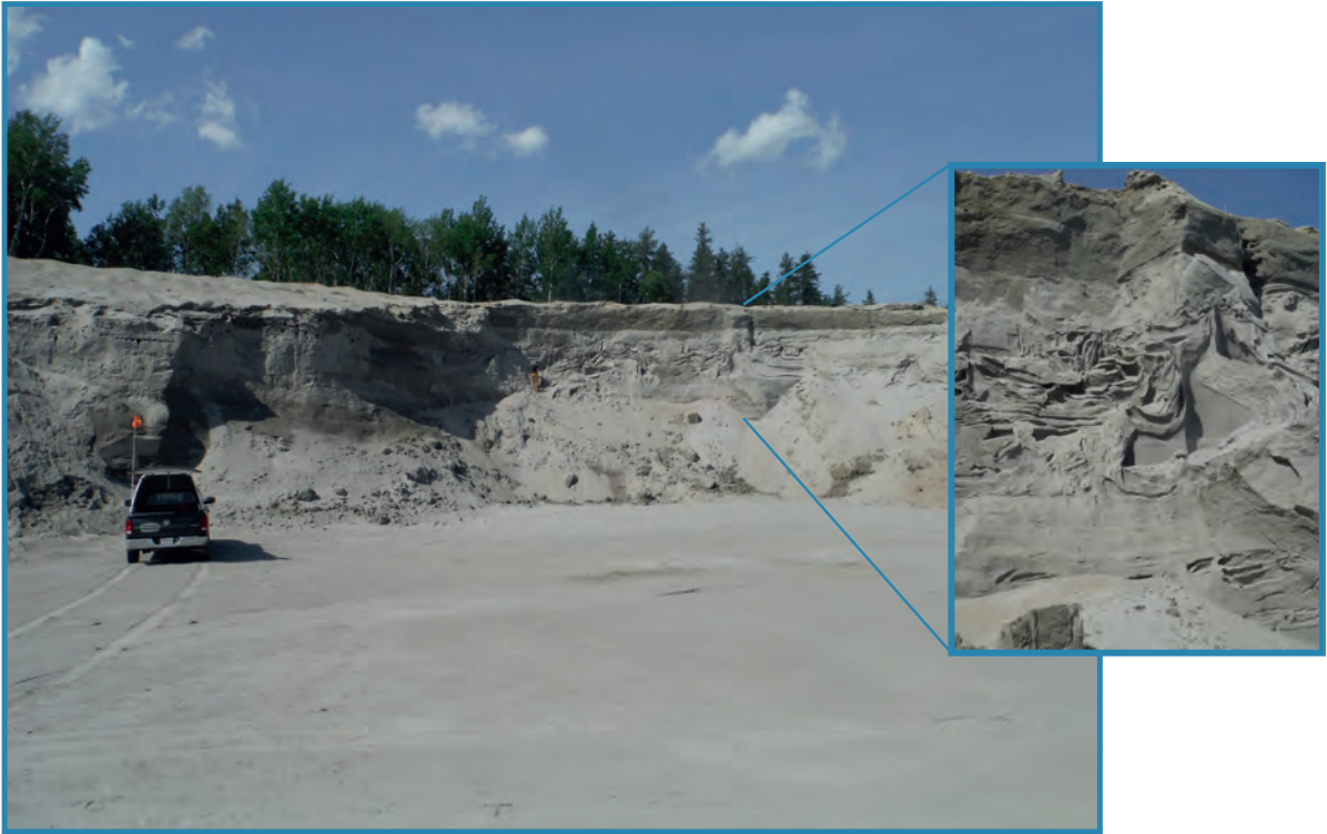
Photo 6 – Face de 8 m de hauteur formée de sable moyen à fin stratifié avec des lits de sable fin à silteux. Présence de structures de déformation (convolutes; site 144, 22D06).
