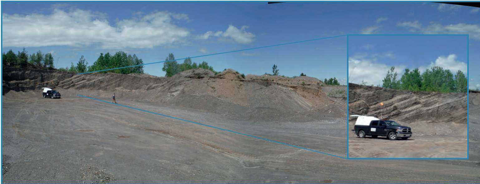
Photo 36 – Faces de 6 à 8 m de hauteur constituées de sable moyen à grossier avec des lits de gravier. Les matériaux sont plus ou moins bien triés et présente des stratifications horizontales et obliques (site 88, 22D05).
