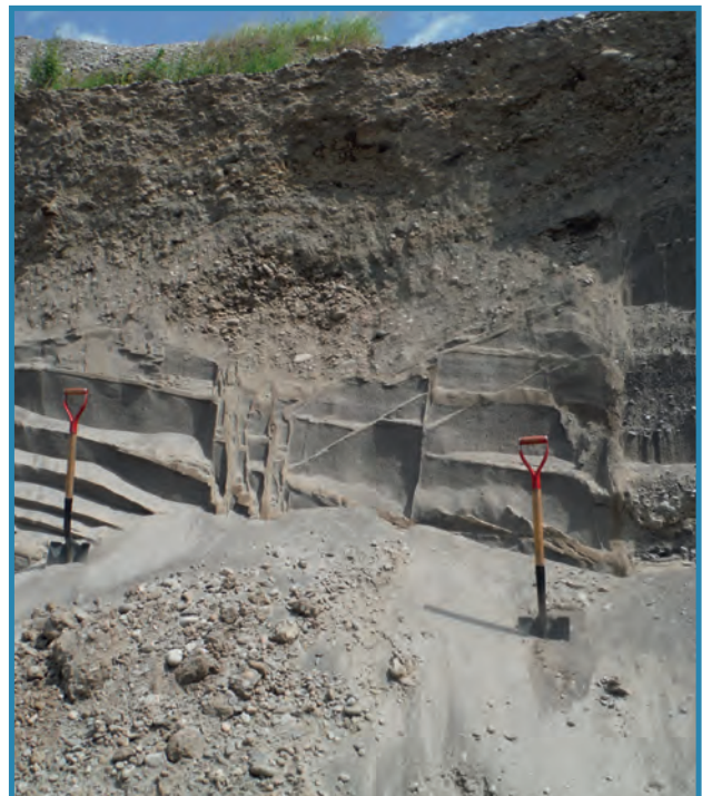
Photo 34 – Delta-kame. Face formée de gravier reposant sur du sable. Présence de failles (site 141, 22D05).
