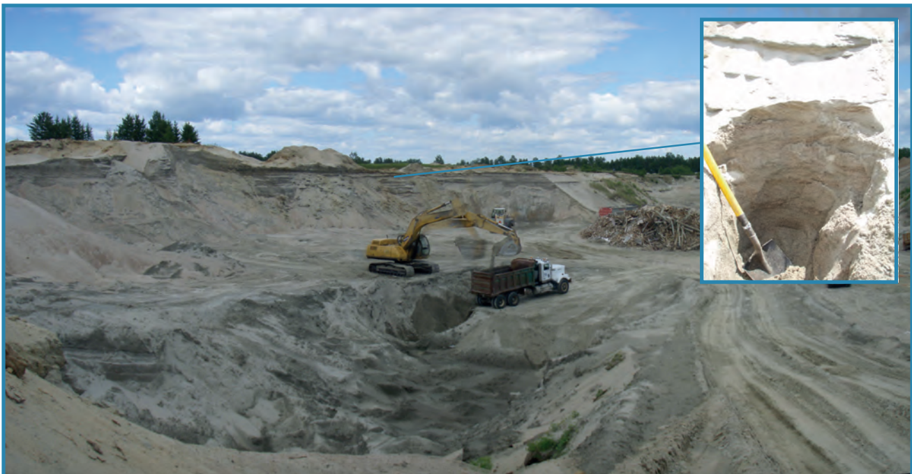
Photo 15 – Sédiments deltaïques. Face de 8 m de hauteur composée de sable moyen à grossier stratifié et bien trié reposant sur 3 à 4 m de sable fin (site 314, 32A16).
