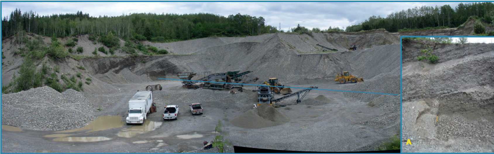
Photo 28 – Dépôt juxtaglaciaire. Faces de 6 à 15 m de hauteur composées de galets (40 à 70 %) et de cailloux (0 à 10 %) dans une matrice sableuse plus ou moins bien stratifiée selon l'endroit (présence de lits obliques) et faces de sable moyen à fin (site 451, 32A08). (A) Vue détaillée.
