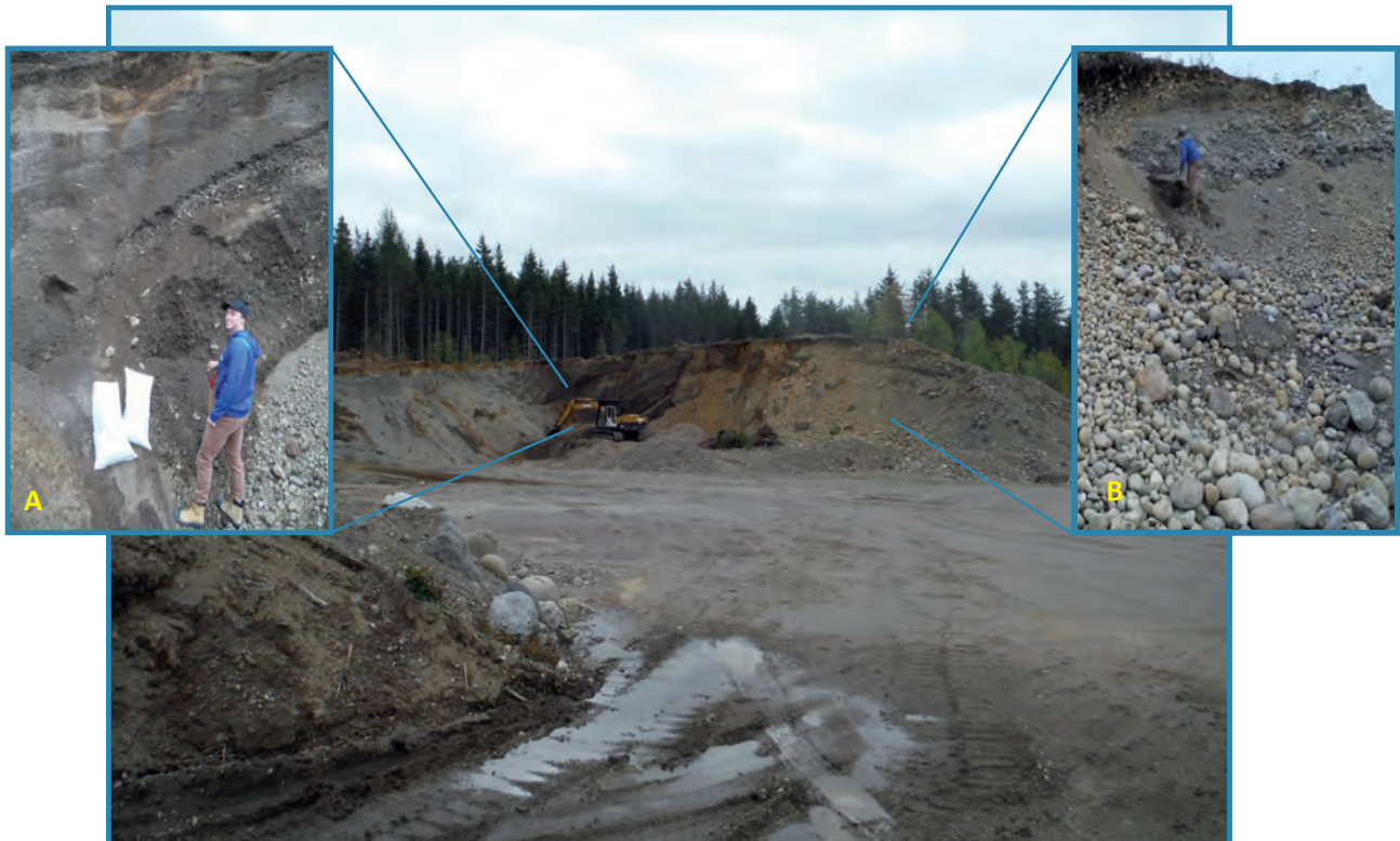
Photo 9 – Dépôt juxtaglaciaire exploité au site 36 (22D11). La granulométrie varie beaucoup. (A) Zone de sable grossier avec lits de graviers. (B) Zone de galets avec cailloux dans une matrice sableuse.
