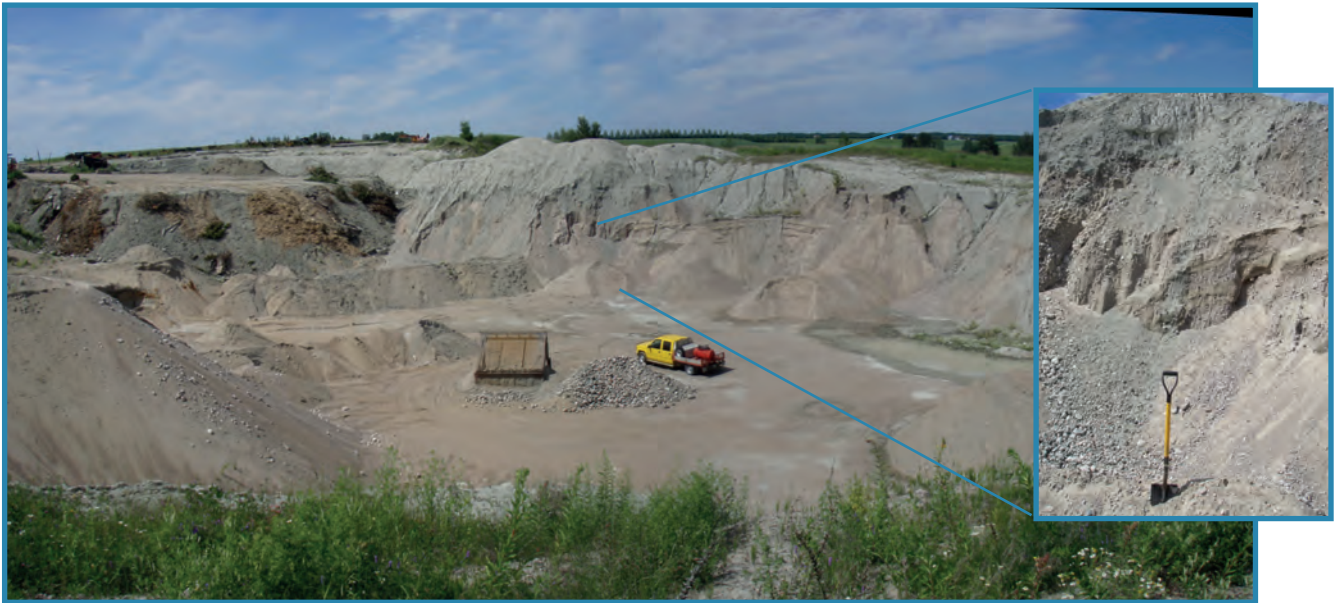
Photo 18 – Sédiments juxtaglaciaires. Face formée de 4 à 8 m de sable moyen à grossier et de galets arrondis plus ou moins bien stratifiés recouverts de 1 à 3 m d'argile glaciomarine (site 321, 32A16).
