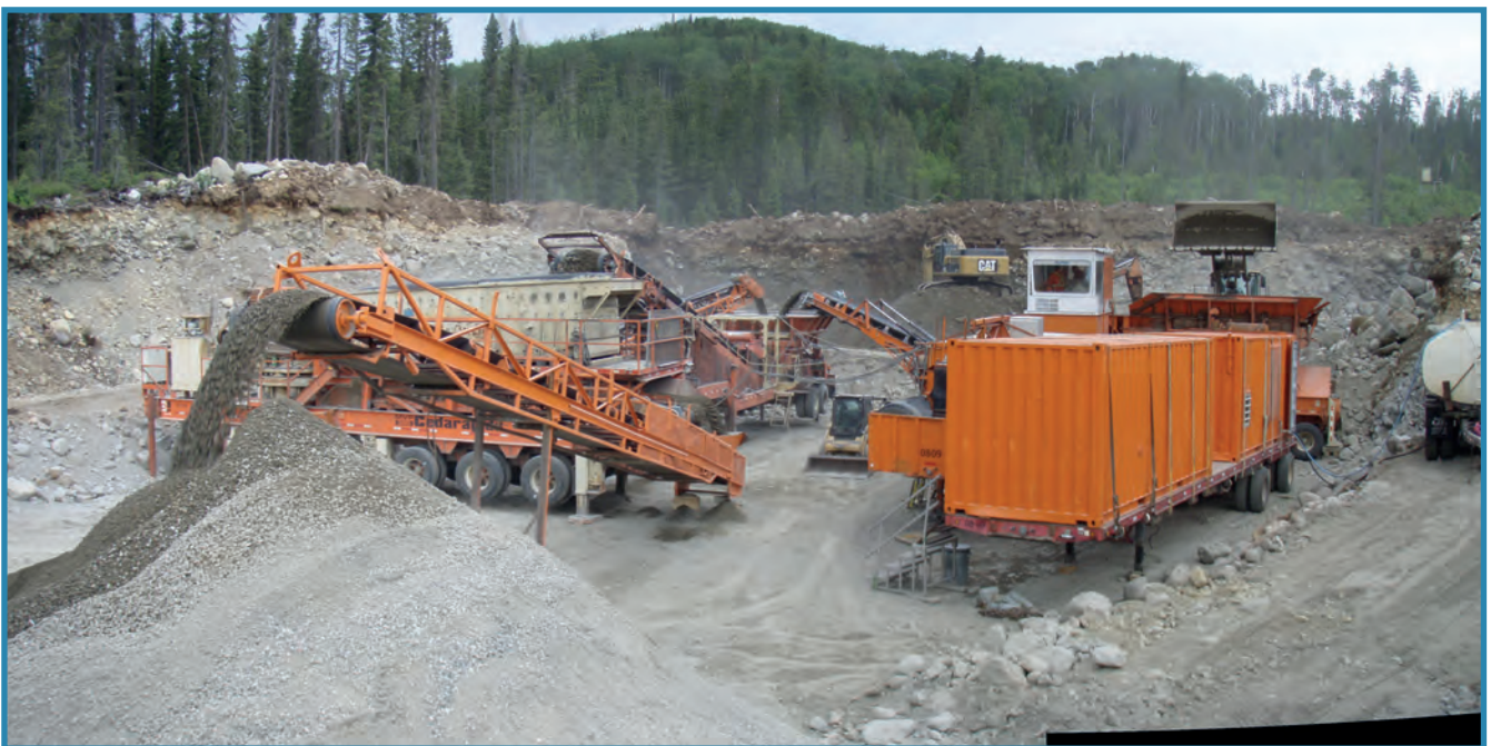
Photo 13 – Face de 3 à 6 m de hauteur formée de galets et de cailloux subarrondis dans une matrice sableuse exploitée pour la production de MG-20 (site 278, 22D13).
