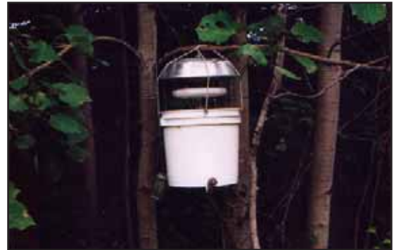
Figure 8. Piège lumineux de type « black light » pour le dépistage des lépidoptères, des diptères et de certains coléoptères (photo : L. Simard)
