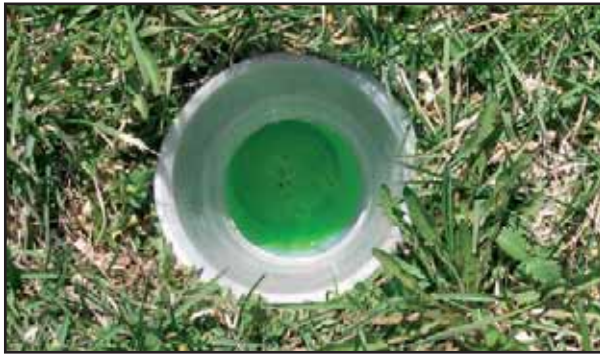
Figure 7b. Piège-fosse. Le piège installé dans le sol (photo : S. Rochefort)
