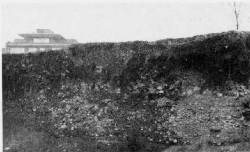
Fig. 10 — Sables et graviers des plages à l'élévation 480 près des rues Ridgewood et Côte-des-Neiges. On remarque le changement brusque des grosseurs des particules.
