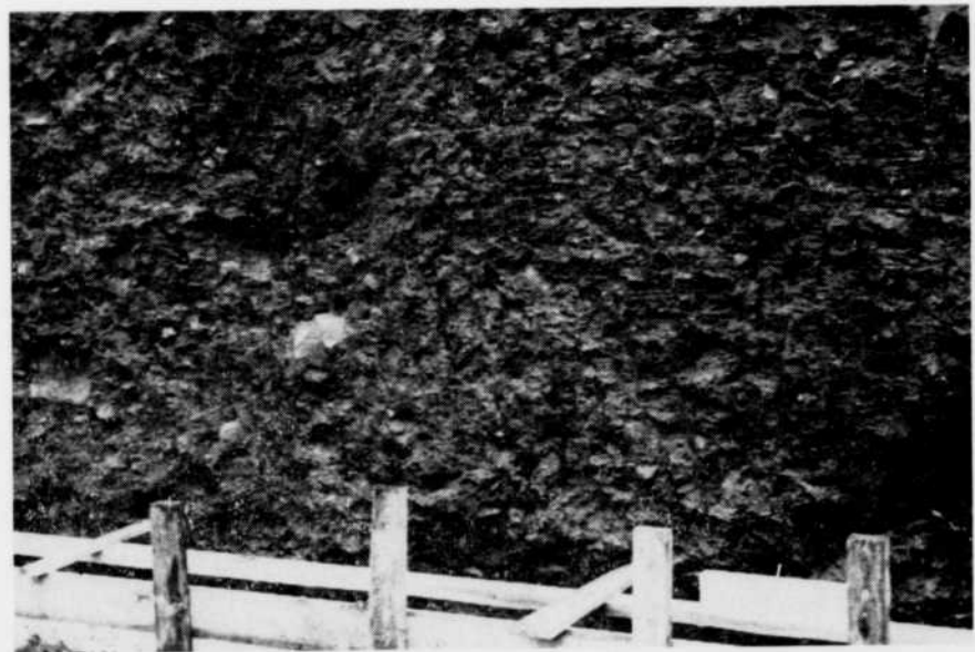
Fig. 8 — Dépôt glacial non stratifié - Till. A l'angle de la rue Masson et de la 12ième avenue.
