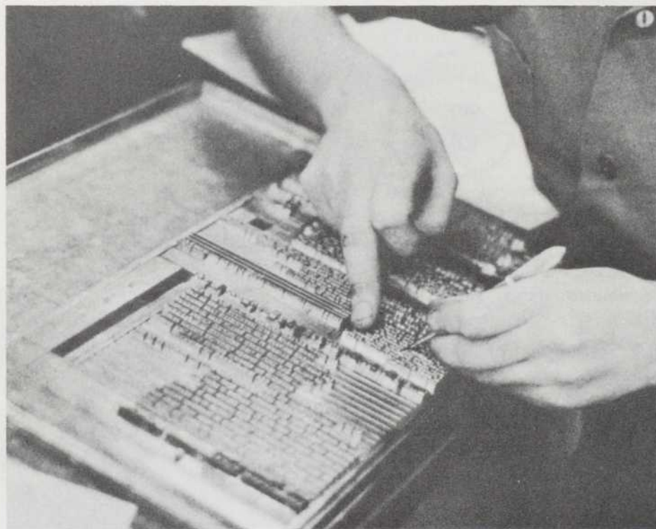
UN TRAVAIL DE MOINE — La composition peut se faire à la main en assemblant les caractères un par un. Ce procédé est encore parfois utilisé pour composer, par exemple, des travaux publicitaires ou des titres d'articles qui demandent de gros caractères.
