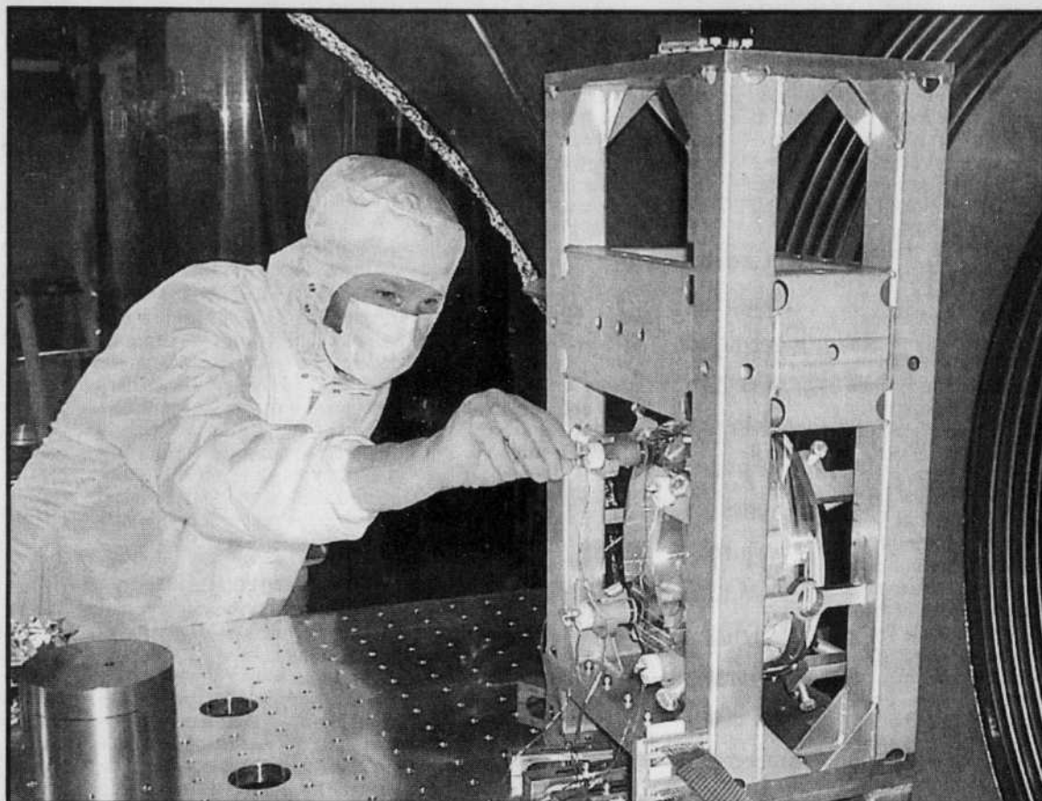
À l'intérieur de l'un des cylindres du LIGO, le chercheur David Shoemaker règle le rayon laser qui sert à détecter les ondes gravitationnelles. L'instrument devrait commencer à livrer bientôt ses premiers résultats, même s'il ne sera pleinement fonctionnel que dans deux ans.
