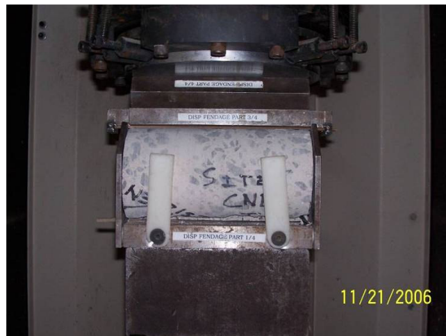
Figure B1-2 – Montage utilisé pour la détermination de la résistance à la traction du béton
