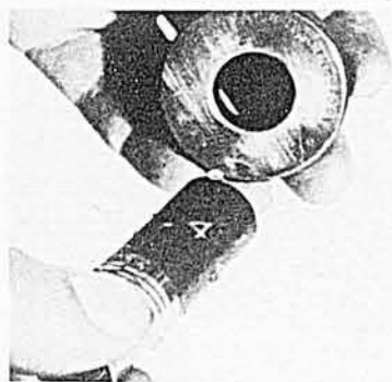
CONTRÔLE DU GONFLEMENT D'UNE CARTOUCHE "IMPERIAL" APRÈS SÉJOUR DANS L'EAU
