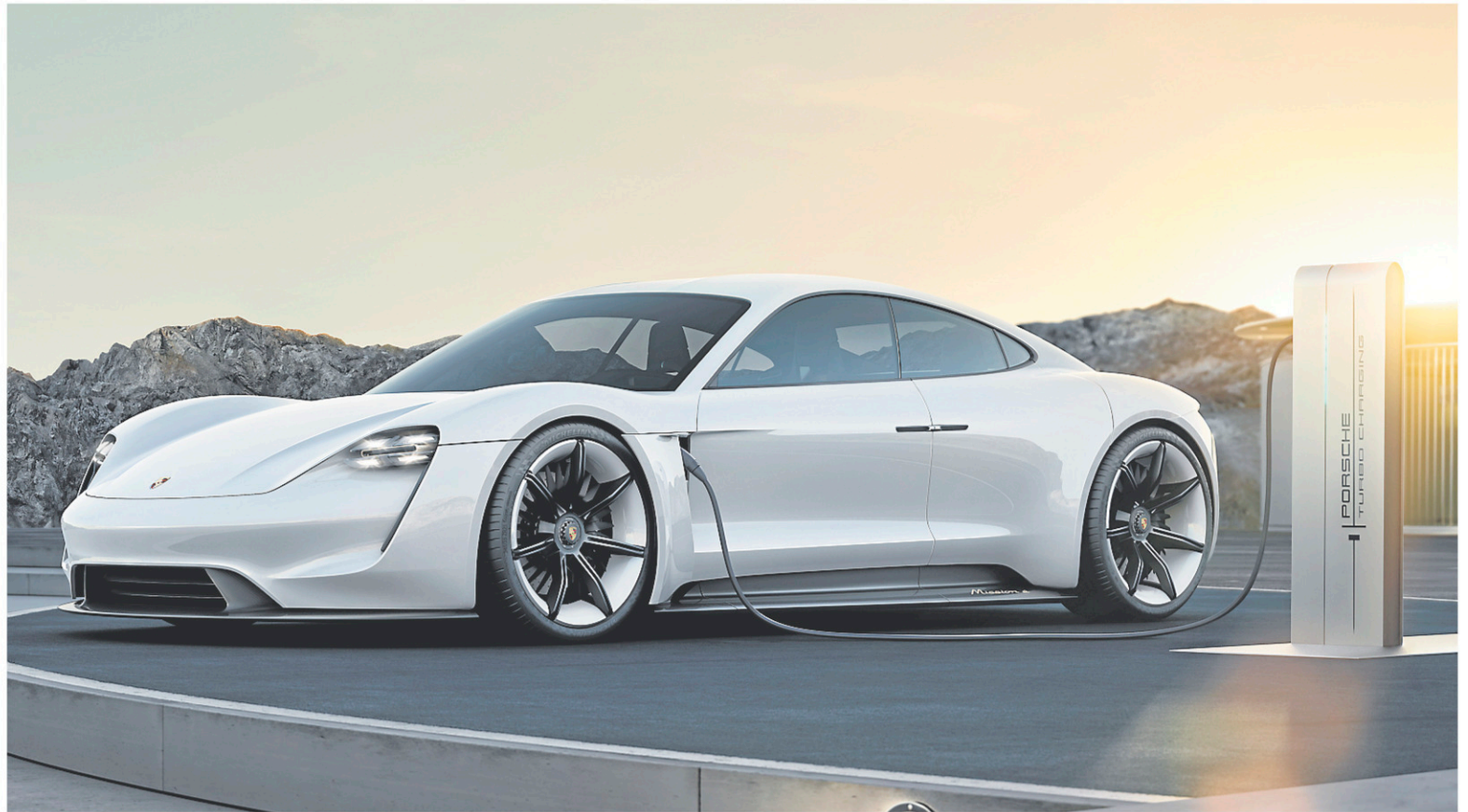
Avec son concept Mission-E, le constructeur Porsche promet une recharge rapide en 15 minutes pour 80 % de la batterie avec des chargeurs de 350 kilowatts. Cette recharge équivaldrait à 400 kilomètres sur une autonomie à pleine charge de 500 km. — PHOTO FOURNIE PAR PORSCHE
