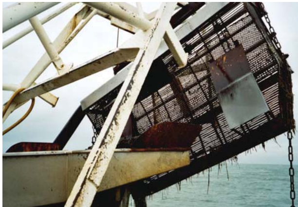
Photo 22 : Remontée et vidange de la drague sur le convoyeur. La capacité de la drague est nettement plus grande sur ce type de navire.
