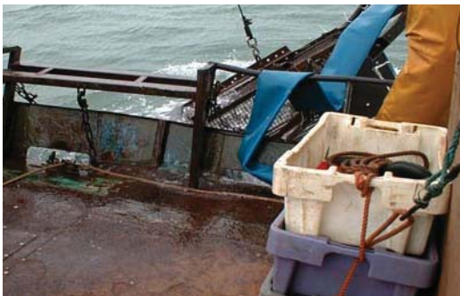
Photo 10 : Arrivée de la drague à bord du « Lady Lorraine ». Notez la structure de réception de la drague et le câble de remontée qui passe sur une poulie.
