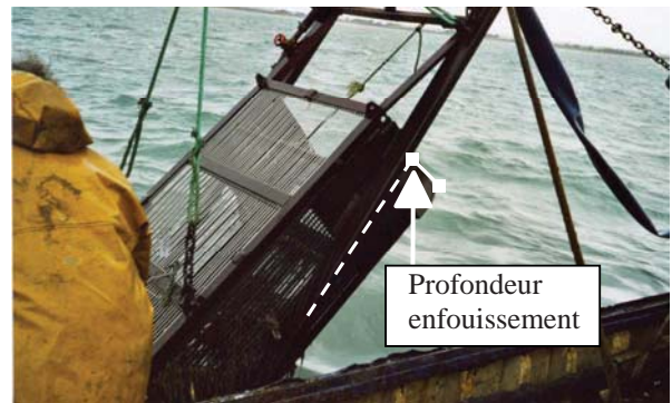
Photo 11 : À la remontée, gros plan de la cage illustrant la fixation des patins qui contrôlent la profondeur de pénétration de la drague.
