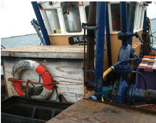
Photo 19 : Détail du système d'alimentation hydraulique de la drague à bord du « Kelly ».
