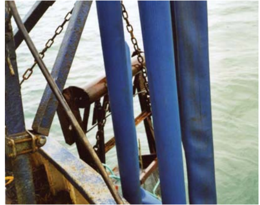
Photo 7 : Plan rapproché de l'avant de la drague hydraulique du « Lady Lorraine » avec tuyau d'alimentation en air en avant-plan.
