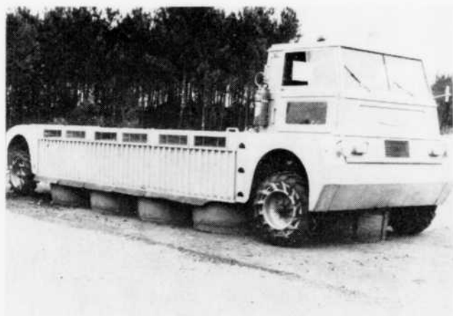
Figure 9 : BC-7 SEDAM. Masse totale, 5 tonnes. Charge utile, 2 tonnes. Endurance, 3 heures. Vitesse sur piste, 50 mi/h, sur terrain varié, 30-40 mi/h, sur eau, 4 mi/h. Moteurs : sustentation, 140 HP, propulsion, 2 x 45 HP, (puissances continues). Longueur, 31.5 pi. Largeur, 10 pi. Hauteur, 9.8 pi.
