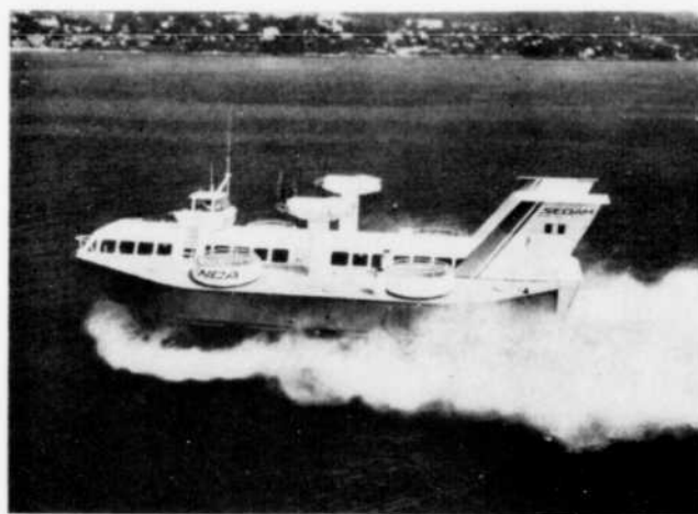
Figure 2 : NAVIPLANE N-300, Société d'Études et de Développement des Aéroglisseurs Marins. Masse totale : 33 tonnes. Charge utile, 13 tonnes (Version cargo). Vitesse maximale, 70 mi/h. Vitesse croisière, 60 mi/h. Endurance, 3 heures. Moteurs Turboméca Turmo 111 N, 2 x 1280 HP, puissance continue. Longueur, 76 pi. Largeur, 36 pi. Hauteur, 26 pi.
