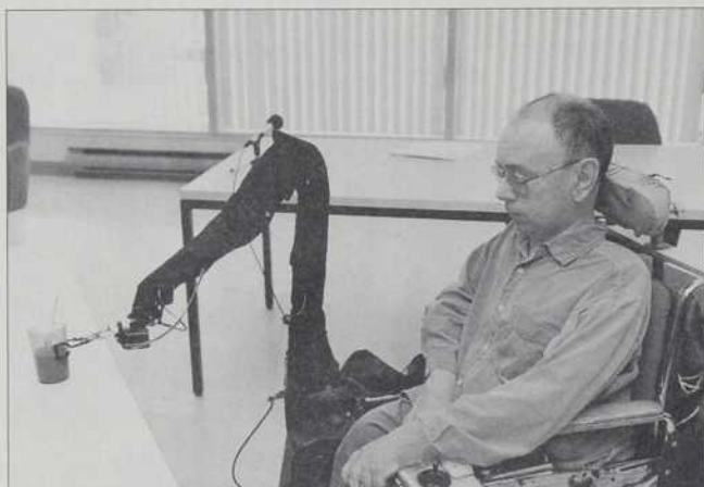
Jacques Forest, l'inventeur du bras Manipulo : « Le bras devait pouvoir ramasser un objet par terre, porter quelque chose à ma bouche tout en étant fiable, silencieux et rapide. »
