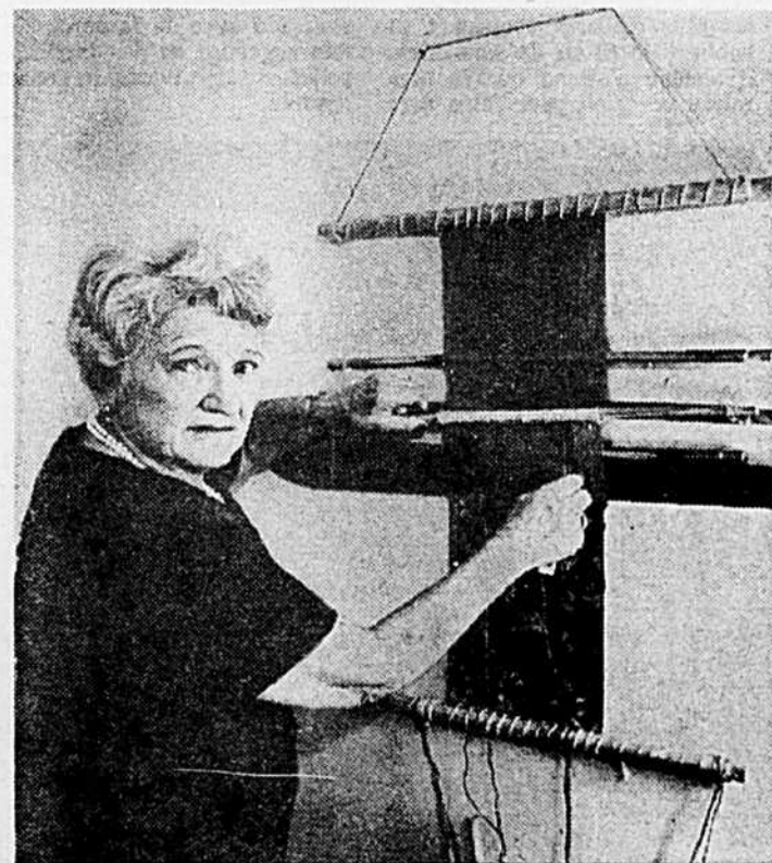
Le métier que les Péruviens utilisent encore. Des aiguilles de bois très fines tiennent lieu de navette. Les bergers, en montagne, accrochent leur métier à un arbre au pied duquel ils s'assoient pour tisser.
