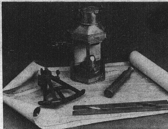
Divers instruments de navigation (fin XIX e et début XX e siècle): octant, fanal, longue vue télescopique, règles parallèles, carte maritime.
