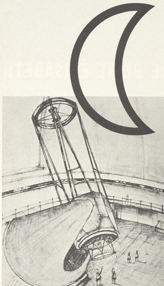
Croquis du télescope et de l'intérieur de la coupole du futur observatoire Reine-Elisabeth. Un miroir parabolique de 150 pouces placé au fond du "tube" pivotant réfléchit la lumière des astres au foyer de l'instrument, c'est-à-dire dans la partie supérieure du tube où une cabine minuscule pourra loger un astronome. Le tableau de commande, à droite, permettra de régler le mouvement du télescope et de la coupole rotative.
