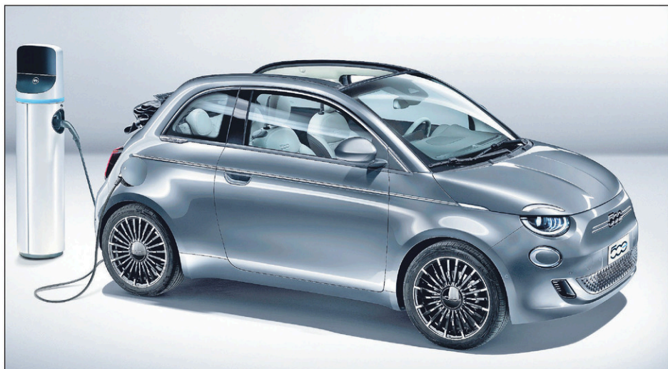
Entièrement refondue, la Fiat 500 est un modèle 100 % électrique. La batterie de 42 kWh procure une autonomie d'environ 320 km.
