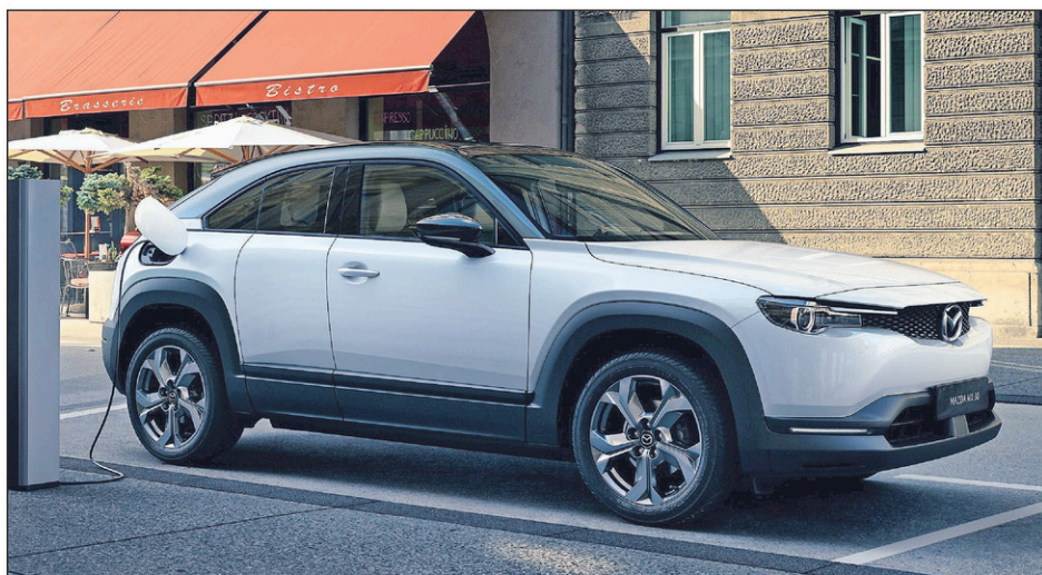
La batterie de 35,5 kWh du Mazda MX-30 prévoit une autonomie d'environ 200 km. Un prolongateur d'autonomie (sur la base d'un moteur rotatif) est dans les plans.
