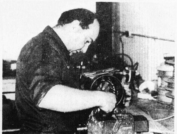
REFILAGE A LA MAIN D'UN Moteur fractionnel ( 1 h.p. et moins )
