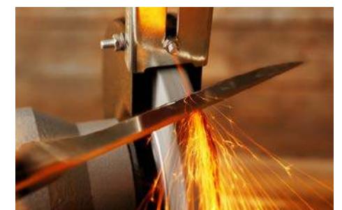
Une lame tranchante est composée d'une arête vive appelée le fil. C'est la partie qui pénètre dans la matière que l'on coupe. Une bonne finition du fil permet de rompre la matière à couper. (Photo : courtoisie)
