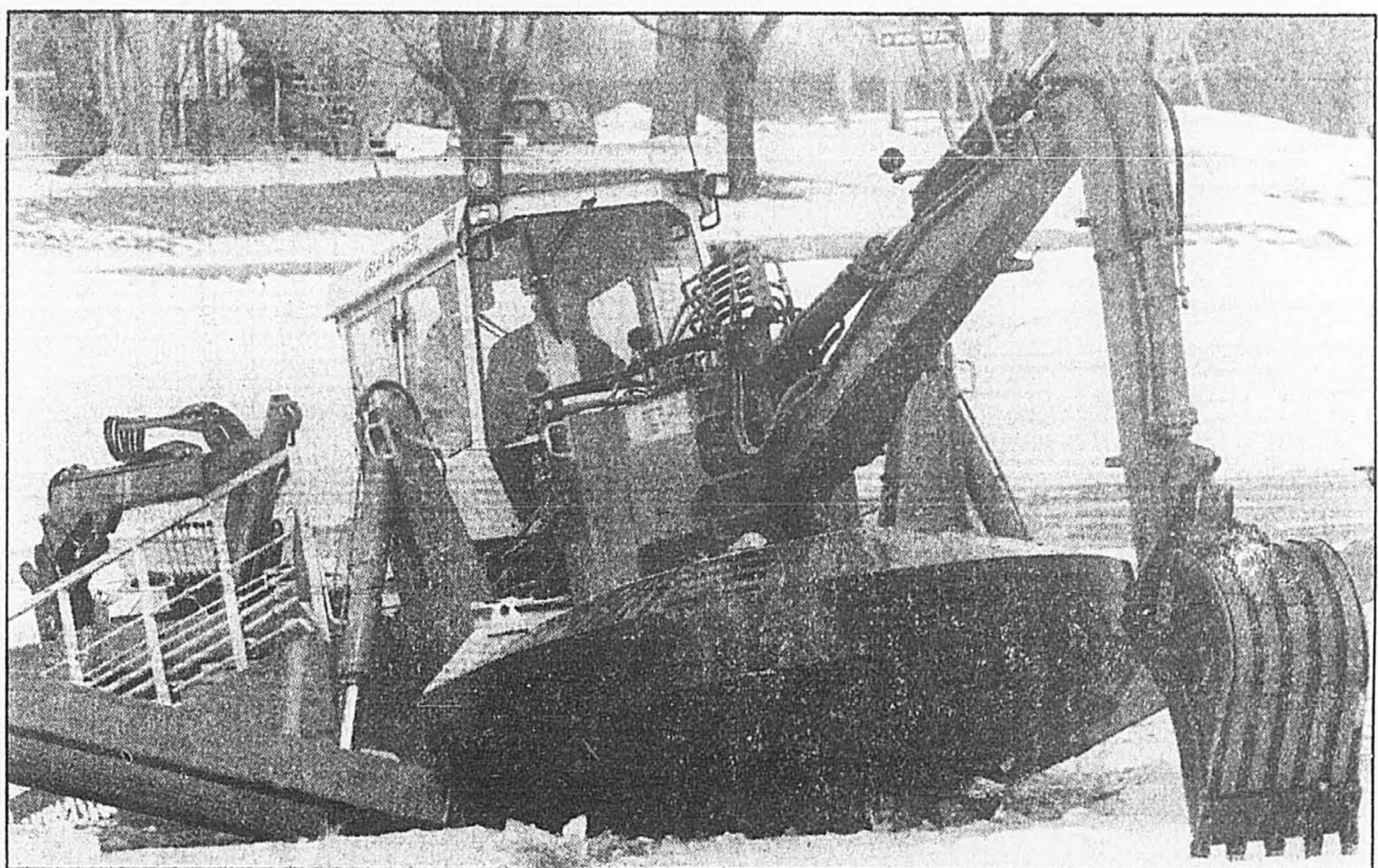
De fabrication finlandaise, cette excavatrice de rivière devient un brise-glace en hiver.
