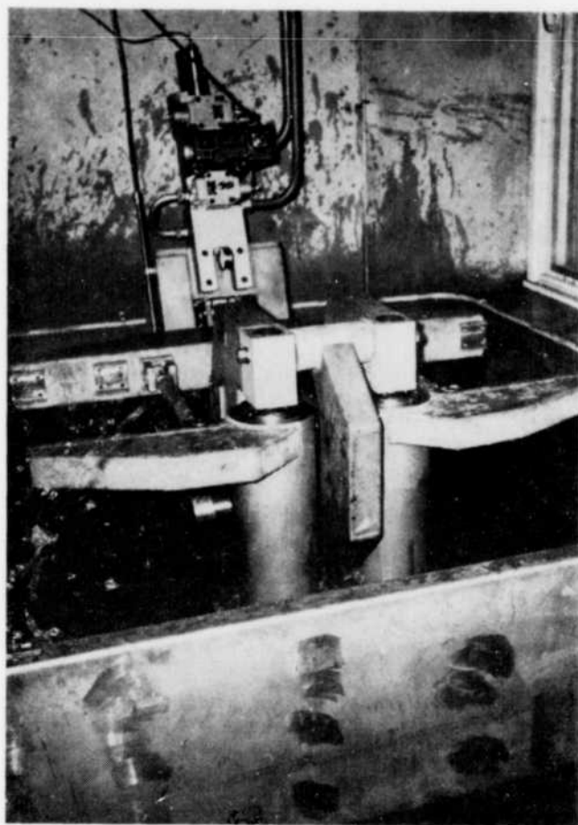
Figure 4 — Ensemble volet, système de bielles et piston hydraulique du batteur à houle.
