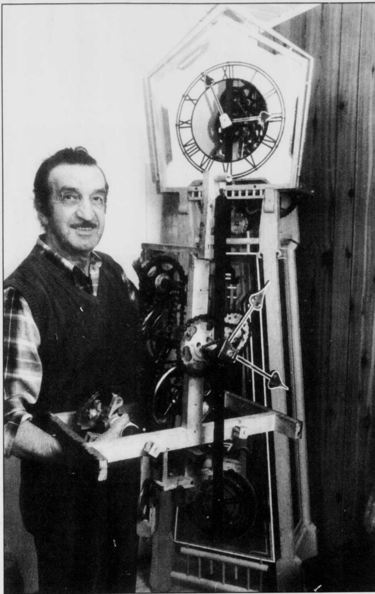
«Patenteux» comme pas un, il y a six ans, M. Germain Blais d'Aston-Jonction s'est lancé dans la fabrication d'horloges énormes dont le mécanisme comporte des pièces d'engrenage de bicyclettes.
