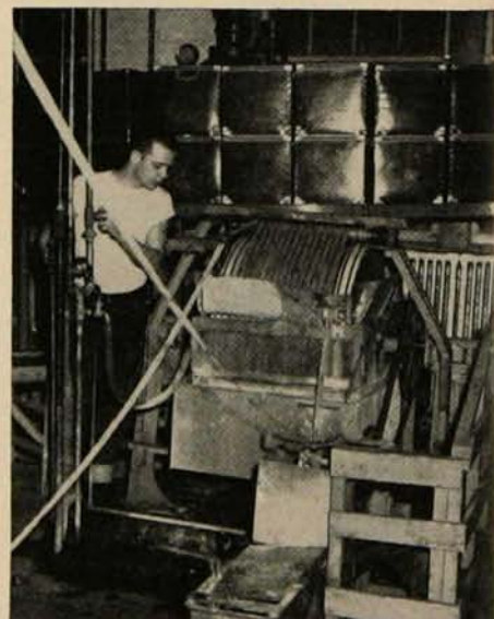
Lessiveuse capable de laver 14 milles de ruban monté par jour.
