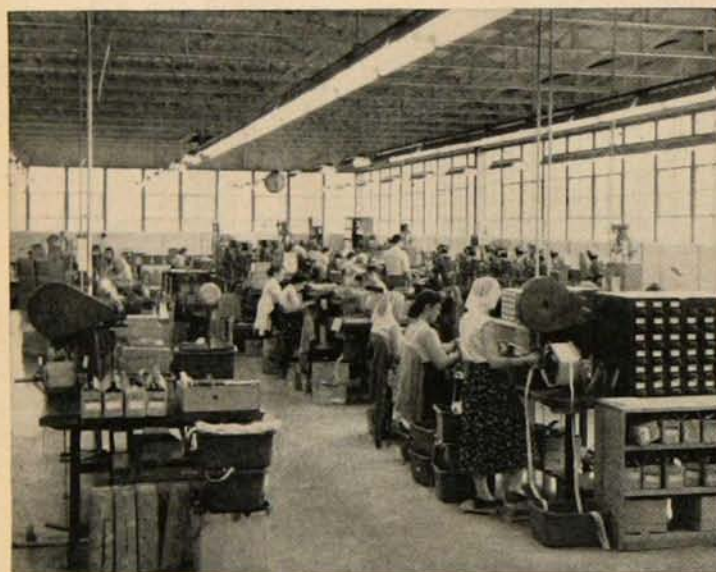
L'assemblage des fermetures éclair dans l'usine moderne de la Cie Lightning Fastener, à Bedford, P. Q.
