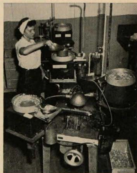
Cette ouvrière alimente une machine à assembler les curseurs.
