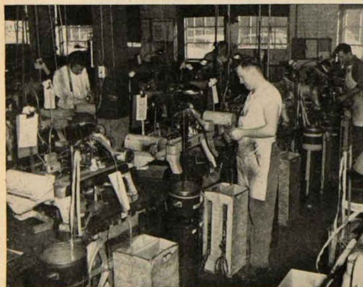
A St. Catharines: cette machine pose les dents des fermetures au ruban liséré à une vitesse inouïe.
