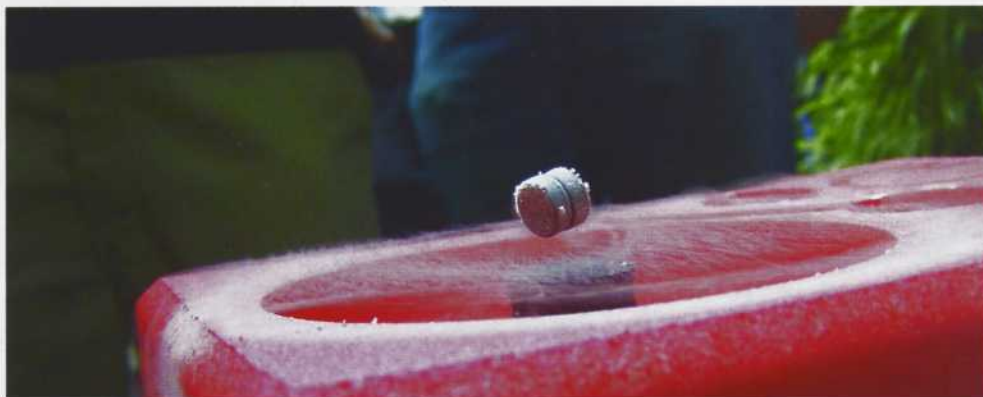
La réalisation d'électro-aimants conducteurs constitue certainement l'application la plus courante de la supraconductivité. On les retrouve dans les domaines de l'imagerie médicale, des accélérateurs de particules, de la lévitation magnétique, avec notamment les trains à sustentation électromagnétique.
