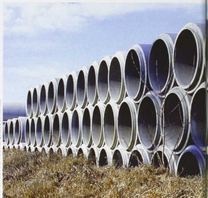
L'utilisation de cendres volantes dans l'élaboration du béton permet de réduire la quantité de ciment, dont la fabrication entraîne l'émission de CO 2 .
